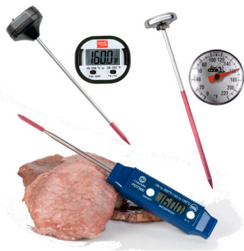
Figura 1. Un termómetro dial de lectura instantánea (a la derecha) muestra la temperatura detectada en las 2 pulgadas inferiores de su vástago. Los termómetros digitales de lectura instantánea (a la izquierda y abajo) muestran la temperatura detectada en la ½ pulgada inferior de su vástago. Un termómetro de punta fina (abajo) detecta la temperatura en la carne delgada.
