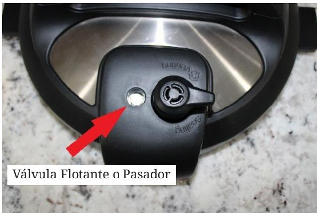
**Figura 2.** Válvula flotante o el pasador. Foto cortesía de Lance Hansen, la Universidad de Idaho.
